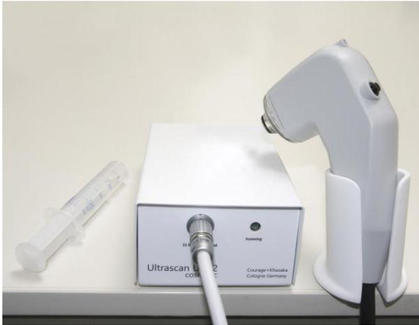
Die Messung mit 22 MHz Ultraschall eignet sich sehr gut, um für verschiedene Anwendungen in die Haut zu blicken.
